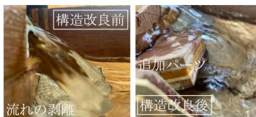
Fig.4 魚道上流端の流況(1/6 模型)
